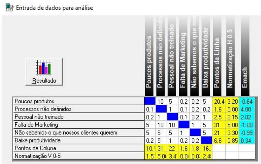
Uma vez calculado o Emach basta pressionar em “Resultado” para se obter a causa raiz, outras causas e os fatores espúrios como mostra a Figura 4.12.
