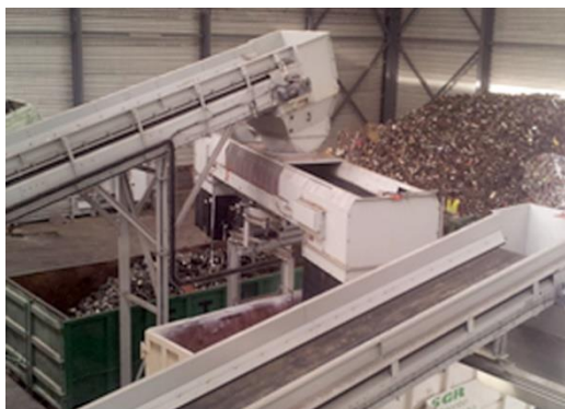
Central de Triagem Semiautomatizada. Acervo FESPSP. PRGIRS (2016).
